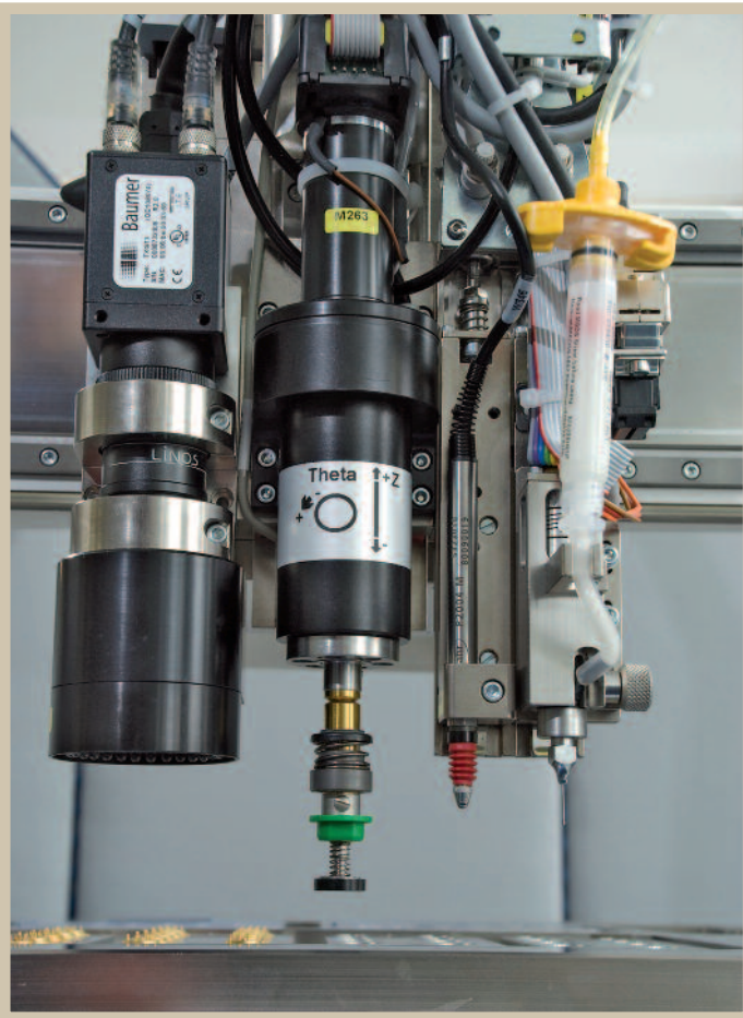
Bild 4. Kopfkongfiguration mit Kamera, Bestückungskopf, Höhenmesstaster und Schraubendosierventil
