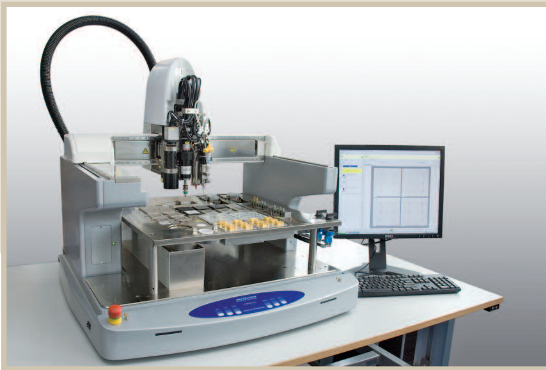
Bild 2. »IP-500«-Desktop als Mikro-montageautomat für opto-elektronische Baugruppen
