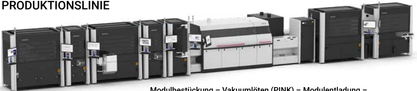
Modulbestückung – Vakuumlöten (PINK) – Modulentladung – Werkstückträgerlift – Rückführtransportsystem unten – Werkstückträgerlift
